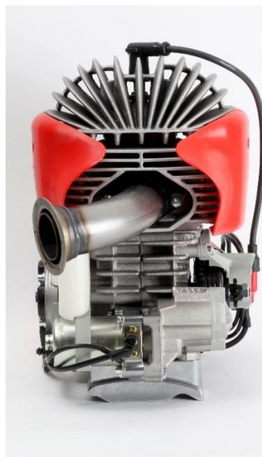
I CONVOGLIATORI DELL'ARIA POSSONO ESSERE MODIFICATI SIA PER AGEVOLARE IL GOMITO DEL PILOTA , SIA PER LO SMONTAGGIO DELL'ACCENSIONE E/O DELLA TESTA DEL MOTORE IN CASO DI VERIFICHE TECNICHE
