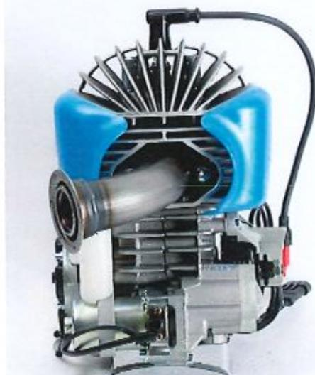
I CONVOGLIATORI DELL'ARIA POSSONO ESSERE MODIFICATI SIA PER AGEVOLARE IL GOMITO DEL PILOTA, SIA PER LO SMONTAGGIO DELL'ACCENSIONE E/O DELLA TESTA DEL MOTORE IN CASO DI VERIFCHE TECNICHE
