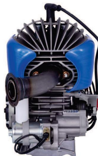
I CONVOGLIATORI DELL'ARIA POSSONO ESSERE MODIFICATI SIA PER AGEVOLARE IL GOMITO DEL PILOTA , SIA PER LO SMONTAGGIO DELL'ACCENSIONE E/O DELLA TESTA DEL MOTORE IN CASO DI VERIFICHE TECNICHE
