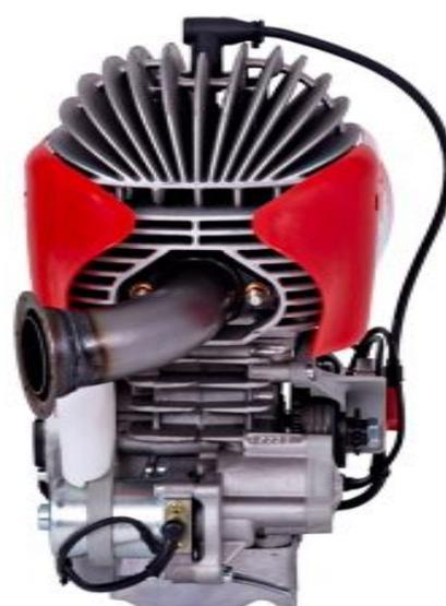
I CONVOGLIATORI DELL'ARIA POSSONO ESSERE MODIFICATI SIA PER AGEVOLARE IL GOMITO DEL PILOTA , SIA PER LO SMONTAGGIO DELL'ACCENSIONE E/O DELLA TESTA DEL MOTORE IN CASO DI VERIFICHE TECNIC
